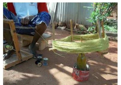
dévidoir, on enroule le fil autour d'une bobine. Cette étape est facultative car on peut travailler directement avec le dévidoir pour la réalisation de l'étape 8. Mais travailler avec les bobines est plus pratique et plus rapide.
